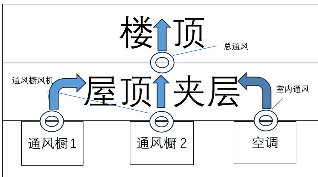
1.所有通风系统均需总通风开启后方可将气体排放至大气，每日进入实验室请打开总通风。总通风功率较大，长时间运转易损坏，每日最后离开实验室时请关闭总通风。开关位于 218 房间外墙壁上，示意图如下：
